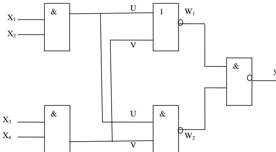
Преобразуем последнее выражение по закону де Моргана. Получаем  $y = ((x1 \&x2) \vee (x3 \&x4)) \vee (x1 \&x2) \&(x3 \&x4)$ .
