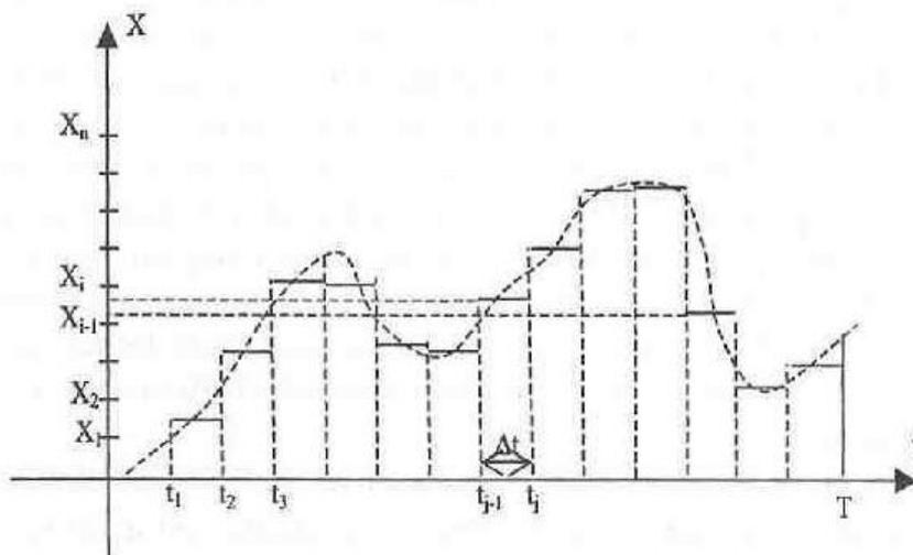
Дискретизация по времени выполняется следующим образом: весь период времени  $T$  разбивается на малые интервалы  $\Delta t$ , точками  $t_1, t_2, \dots, t_n$ . Предполагается, что в течении интервала времени  $\Delta t$  уровень сигнала изменяется незначительно и может с некоторым допущением считаться постоянным. Величина  $\nu = 1/\Delta t$  называется *частотой дискретизации*. Она измеряется в герцах (Гц) – количество измерений в течении секунды.
